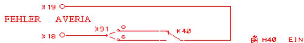
Punto 4. Esquema de la salida de avería X18-X19
